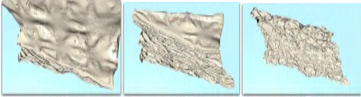
Abb. 16: gescanntes Tuch faltet sich in einem simulierten Sturz wie Aluminiumfolie
